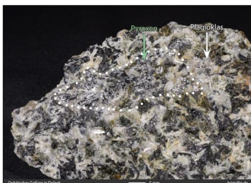
Bild 9: Ophitisches Gefüge: Große Pyroxene umschließen viele kleine Plagioklase
