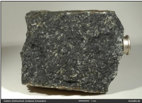
Bild 1: Gabbro (angefeuchtet) mit Magnet
