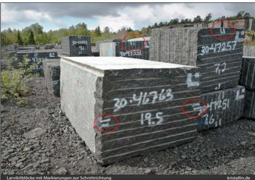
Bild 26: Fertige Ware im Blocklager (19,5 = Gewicht in Tonnen)
