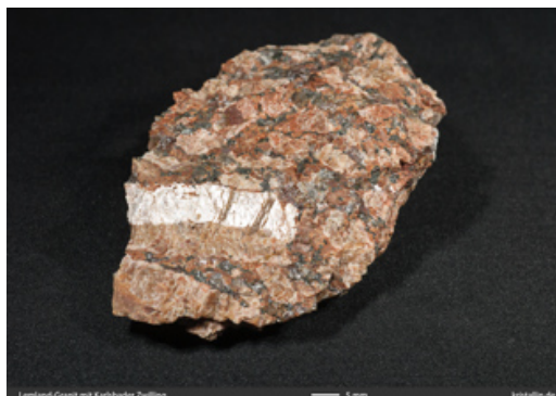
Bild 5 (links): Die großen Alkalifeldspäte sind perthitisch entmischt und fleckig (Probe von Helene von der Heide)
